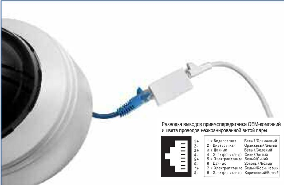
Компания NVT поставляет малогабаритные модули приемопередатчиков на конвейеры ведущих производителей аналоговых видеокамер. Будучи уже встроенными в корпус видеокамеры данные модули позволяют интегрировать такие видеокамеры непосредственно в структурированные кабельные системы, построенные на неэкранированной витой паре и оборудовании компании NVT. Ниже приведен перечень этих изготовителей и разводка выводов в соответствии со стандартом EIA/TIA 568B.
