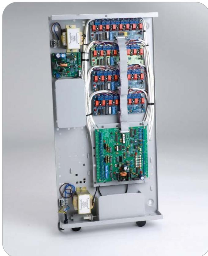
НА РИСУНКЕ: Универсальный модуль расширения с подключенными к нему 4 платами управления лифтами. В этой конфигурации возможен контроль 32 этажей.
